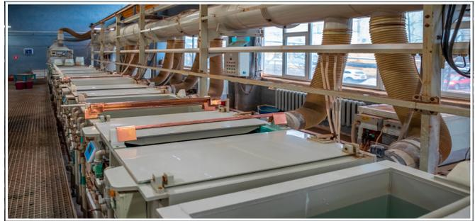
Abb. 2: Ätzsäurebehälter zum Verzinken von Metallteilen in einer Galvanikwerkstatt
