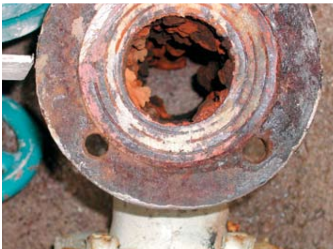
■ In alten Rohrnetzinstallationen finden sich fast überall derart stark inkrustierte Rohrabschnitte, die Bakterien einen idealen Nährboden bieten.
