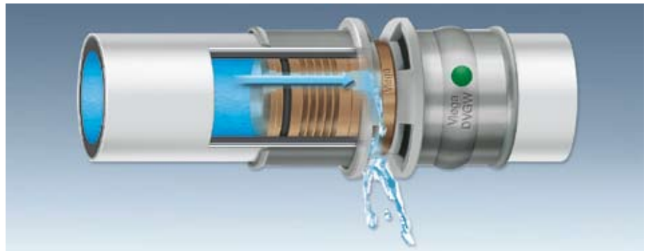
Bild 5: Zwangsdichtheit bei unverpressten Verbindungen sorgen für Sicherheit.
