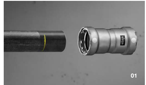
Das Stahlrohr ablängen, entgraten, reinigen und die Einstecktiefe des Pressverbinders auf dem Rohrende markieren
