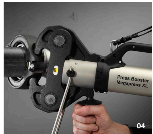
Die XL-Dimensionen 2\frac{1}{2} bis 4 Zoll werden mit einer Viega Pressgun und dem Pressgun-Press Booster einfach, schnell und sicher verpresst (zwei Presshübe der Pressgun notwendig)
