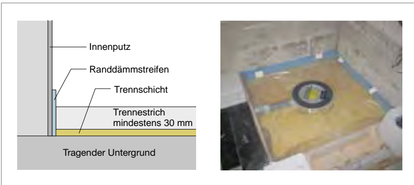
Abb. 279: Der Randdämmstreifen muss lückenlos und vollständig auch hinter dem Bodenablauf durchgeführt werden und dabei großzügig über der Estrich-Oberkante überstehen.
