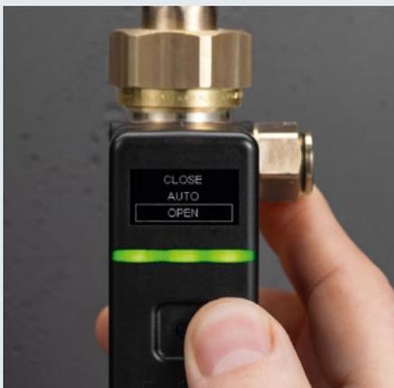
Das Hauptmenü: schließt und öffnet das Ventil und startet den Automatikbetrieb.
