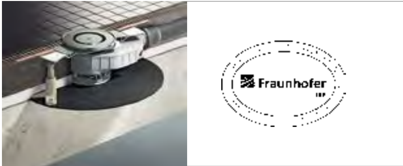
Abb. 265: Nicht nur die Schallentkopplung der Montagefüße ist wichtig. Durch die im Lieferumfang enthaltene Schallschutzmatte lassen sich sowohl die Funktionsgeräusche als auch der Trittschall erheblich reduzieren. Der Ablauf Advantix-Top erfüllt alle Schallschutzstufen nach der VDI-Richtlinie 4100.
