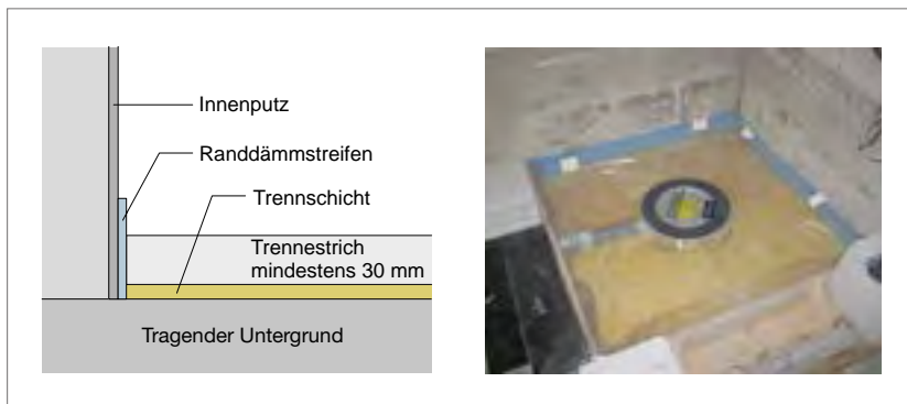
Abb. 272: Der Randdämmstreifen muss lückenlos und vollständig auch hinter dem Bodenablauf durchgeführt werden und dabei großzügig über der Estrich-Oberkante überstehen.
