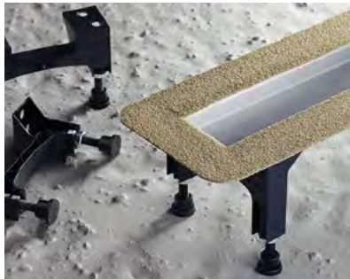
Abb. 275: Advantix-Duschrinnen in der Schallprüfung
