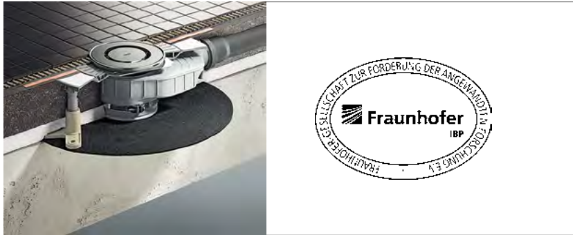
Abb. 273: Nicht nur die Schallentkopplung der Montagefüße ist wichtig. Durch die im Lieferumfang enthaltene Schallschutzmatte lassen sich sowohl die Funktionsgeräusche als auch der Trittschall erheblich reduzieren. Der Ablauf Advantix-Top erfüllt alle Schallschutzstufen nach der VDI-Richtlinie 4100.
