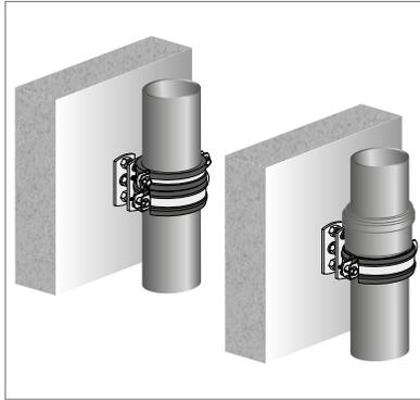
Abb. 250: Rohrschelle mit Entsorgungsleitungen – Beispiele: Festpunkte
