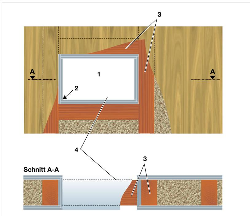
Abb. 149: Öffnungen in Holzbalkendecken mit Brandschutzbekleidung nach Abschnitt 3.2
