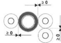
Alle Schalen sind mit verz. Bindedraht  $d \geq 0,7$  mm mit 6 Wicklungen lfd. M. zu fixieren
