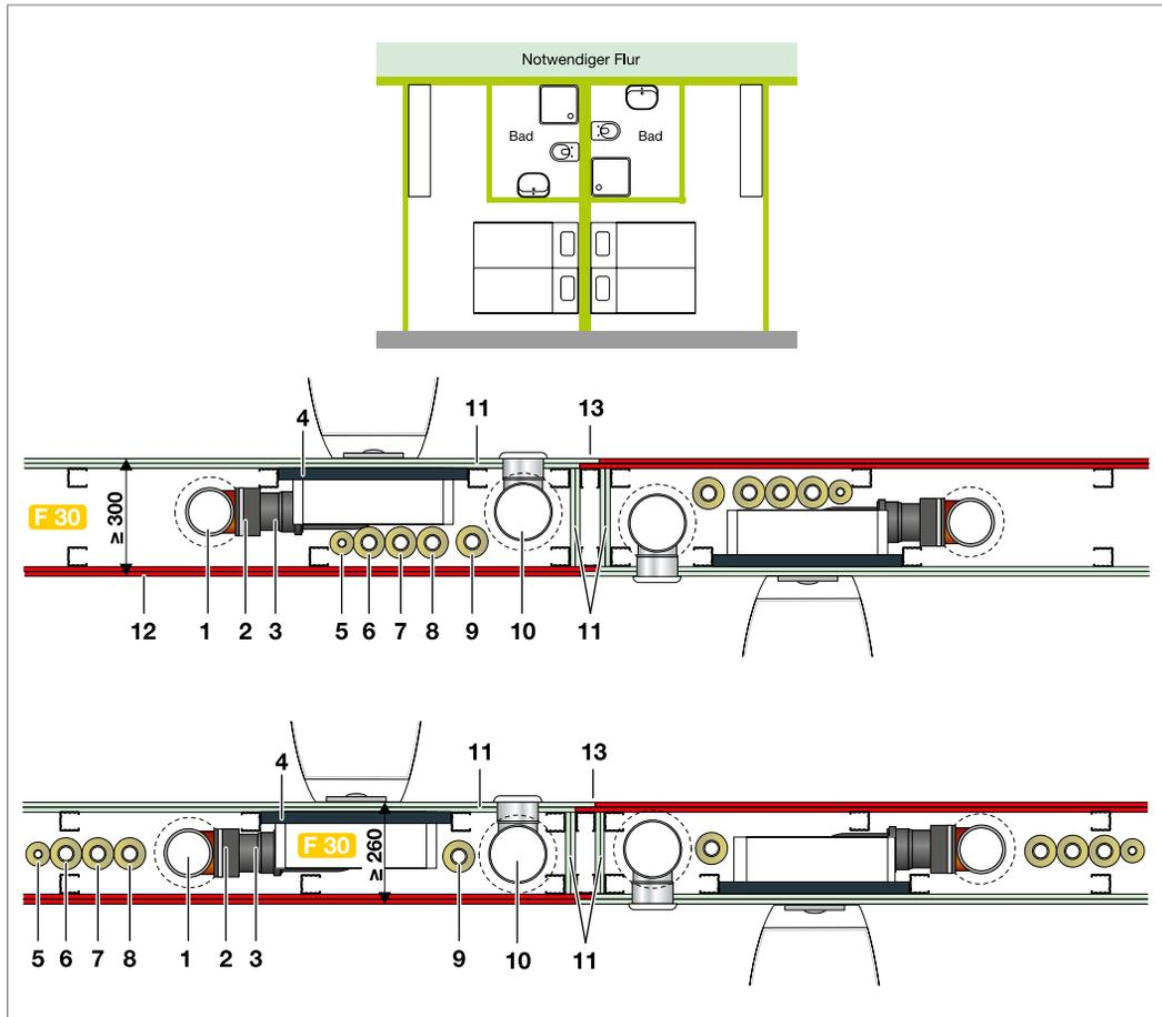
Abb. 217: F 30 Leichte Trennwand mit beidseitiger Wandbelegung
