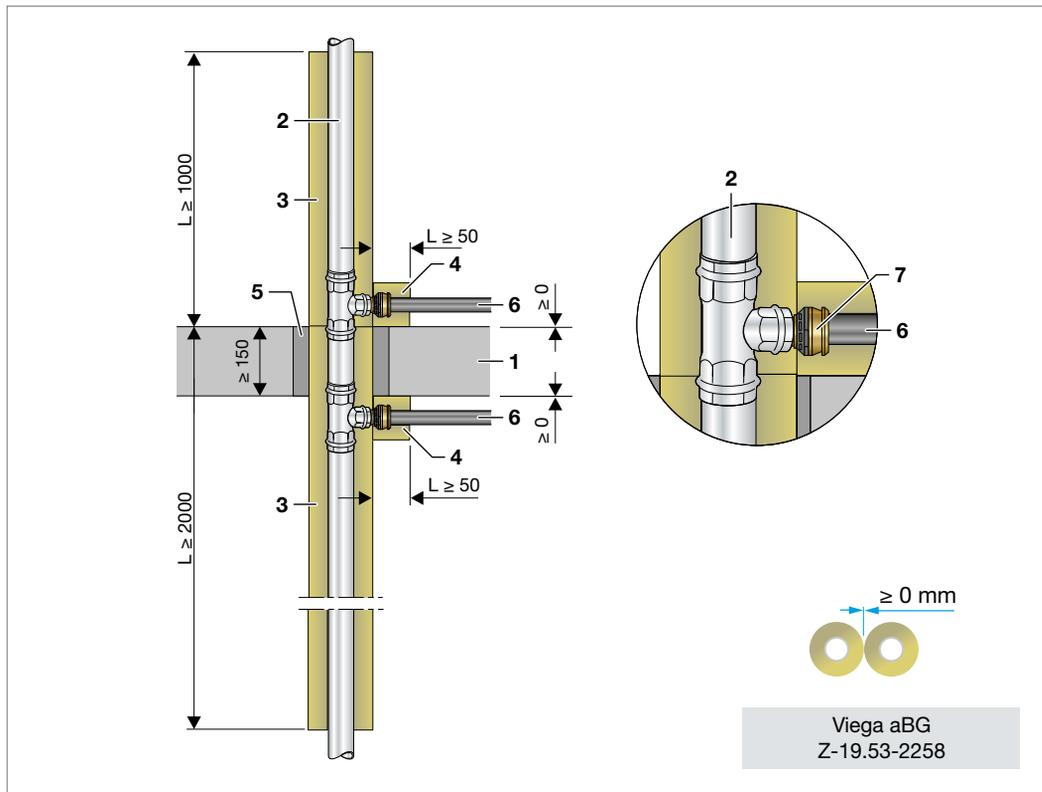
Abb. 86: Etagenanbindung mit G4 Industrial Pipe Inox und Übergang auf Raxofix/Sanfix Fosta
