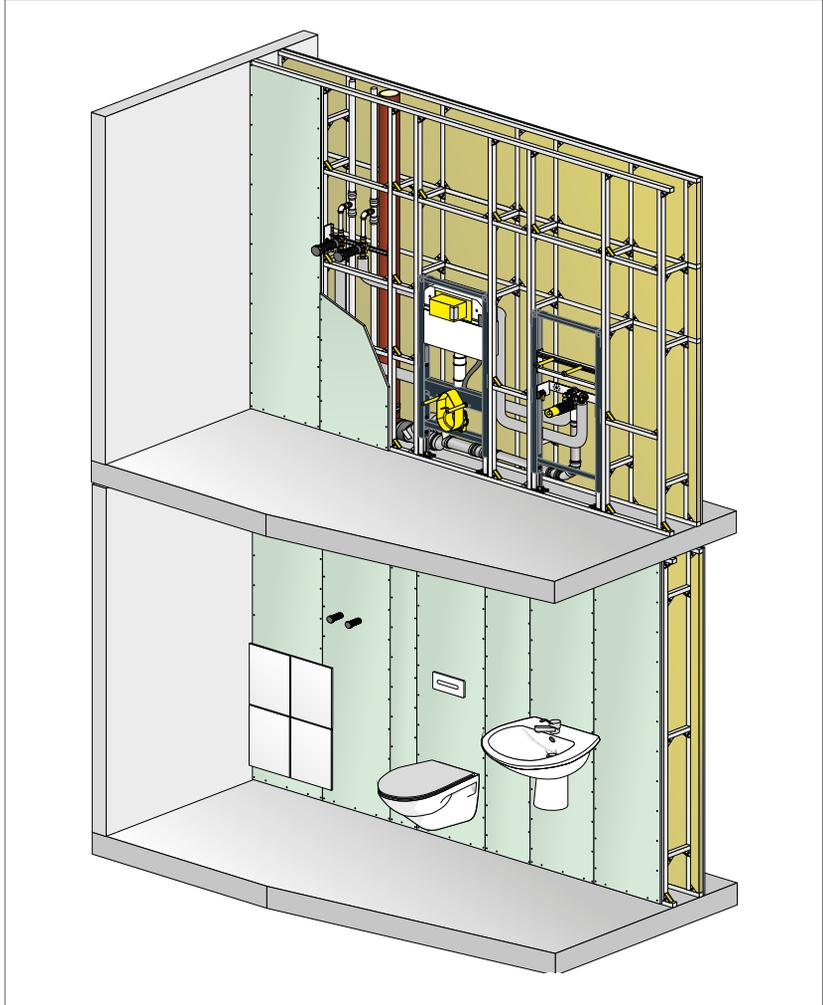
Abb. 286: Installationswand mit Prevista Dry Plus
