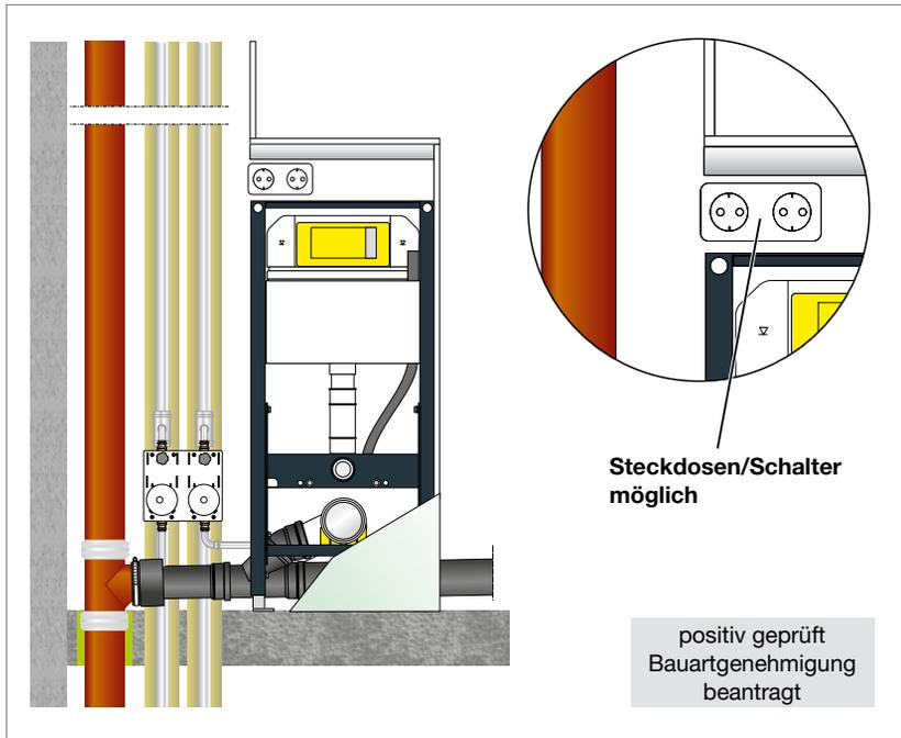
Abb. 55: Geprüfte Einbauten bei Viega Mischinstallation Entsorgung
