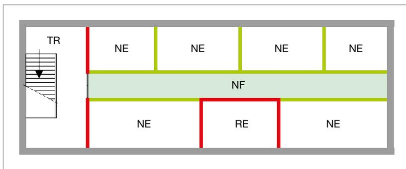
Abb. 205: Notwendiger Flur und Trennwände nach Musterbauordnung — MBO
