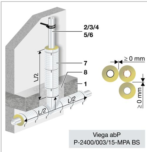
Abb. 121: Einbauvariante T-Stück
