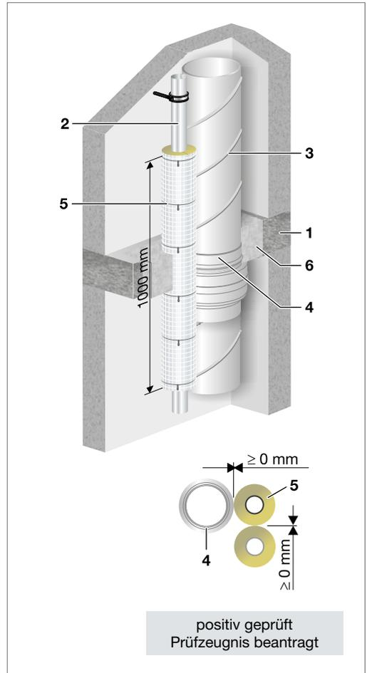
Abb. 138: 0-Abstand zu Absperrvorrichtungen
