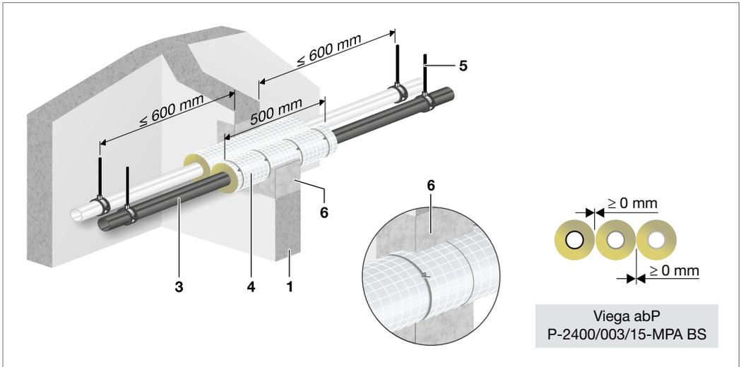
Abb. 158: Raxofix/Sanfix Fosta, d 16 - 63 mm – Einbau in Massivwand
