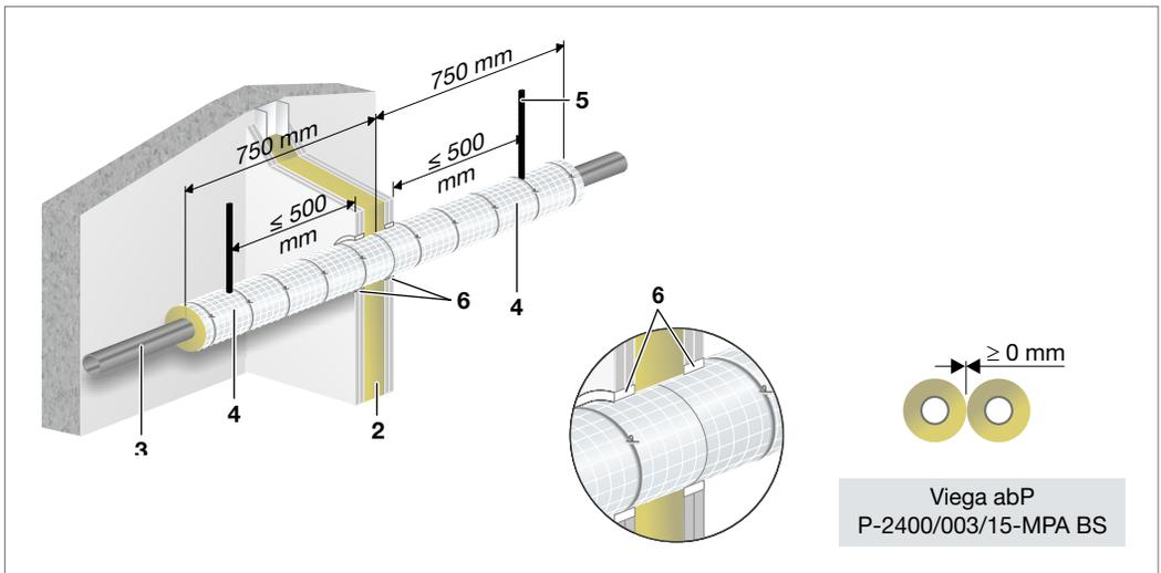
Abb. 157: Megapress – Einbau in leichte Trennwand
