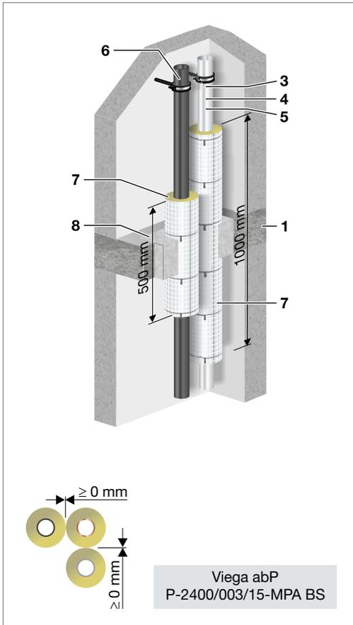
Abb. 117: Nullabstand Viega Metallrohrsysteme zu Raxofix/Sanfix Fosta
