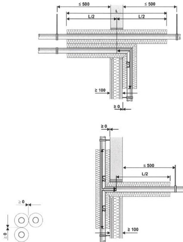
Alle Schalen sind mit verz. Bindedraht  $d \geq 0,7$  mm mit 6 Wicklungen lfd. M. zu fixieren
