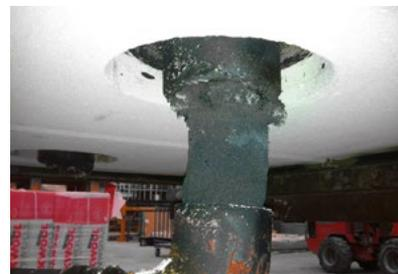
Abb. 239: nach Brandversuch - Gussleitung verschlossen
