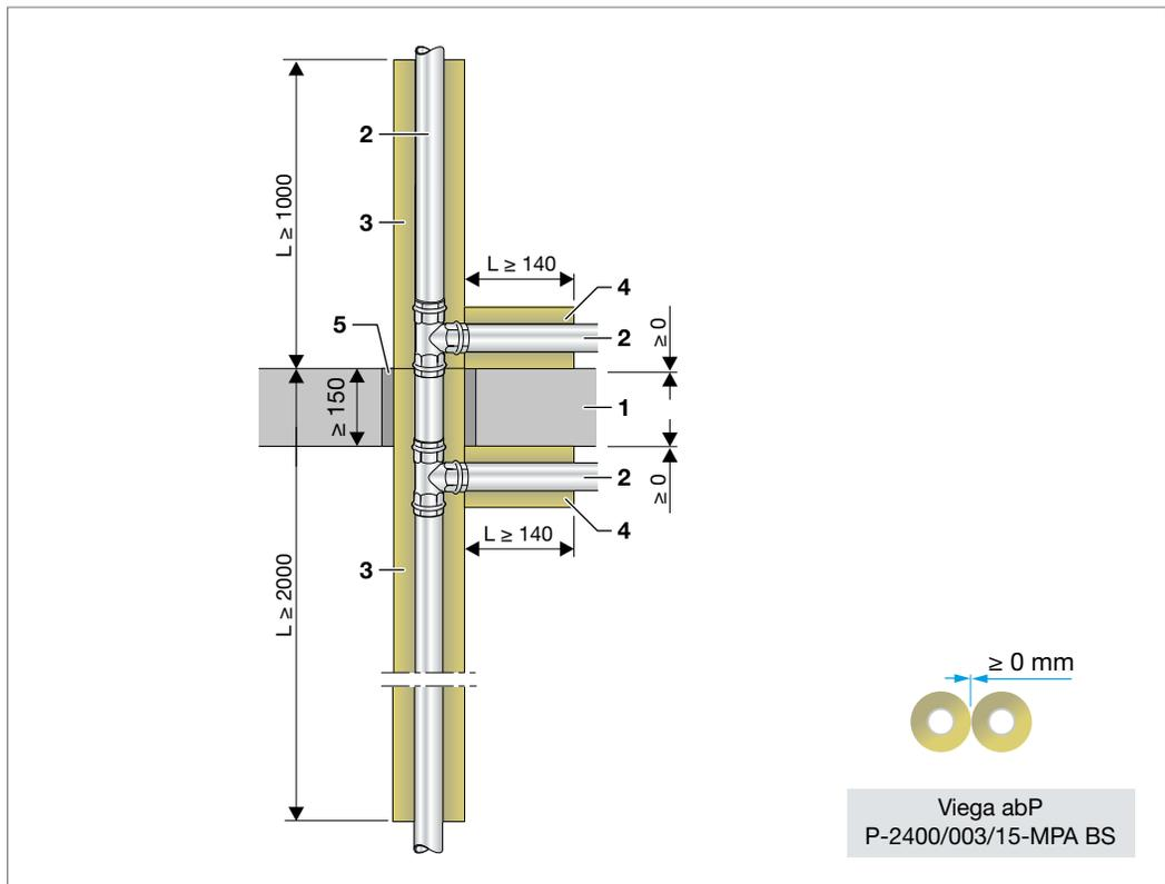
Abb. 82: Etagenanbindung mit G4 Industrial Pipe Inox
