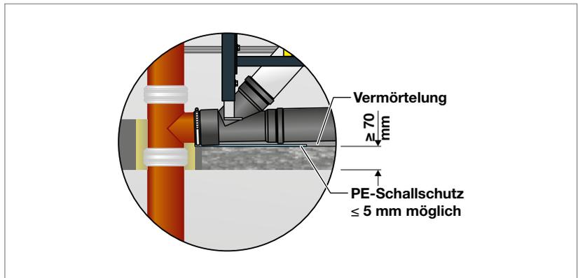
Abb. 51: Detail/Tiefer Einbau
