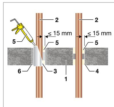
Abb. 188: Viega Brandschutz-Kitt-Abschottung mit Hüllrohr oder in Kernbohrung
