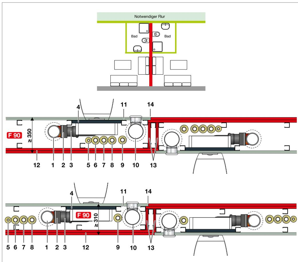
Abb. 218: F 90 Leichte Trennwand mit beidseitiger Wandbelegung
