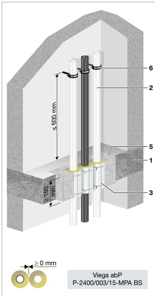
Abb. 111: Raxofix/Sanfix Fosta,  $d \leq 32$  mm
