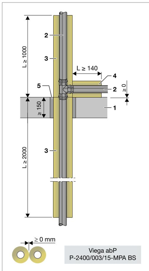
Abb. 103: Etagenanbindung mit Megapress
