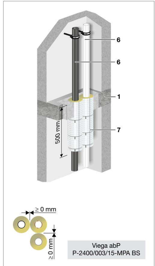
Abb. 118: Nullabstand Viega Rohrleitungssysteme Raxofix zu Sanfix Fosta
