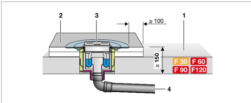
Abb. 231: Bodenablauf – Aufdoppelung  $\geq 100$  mm umlaufend
