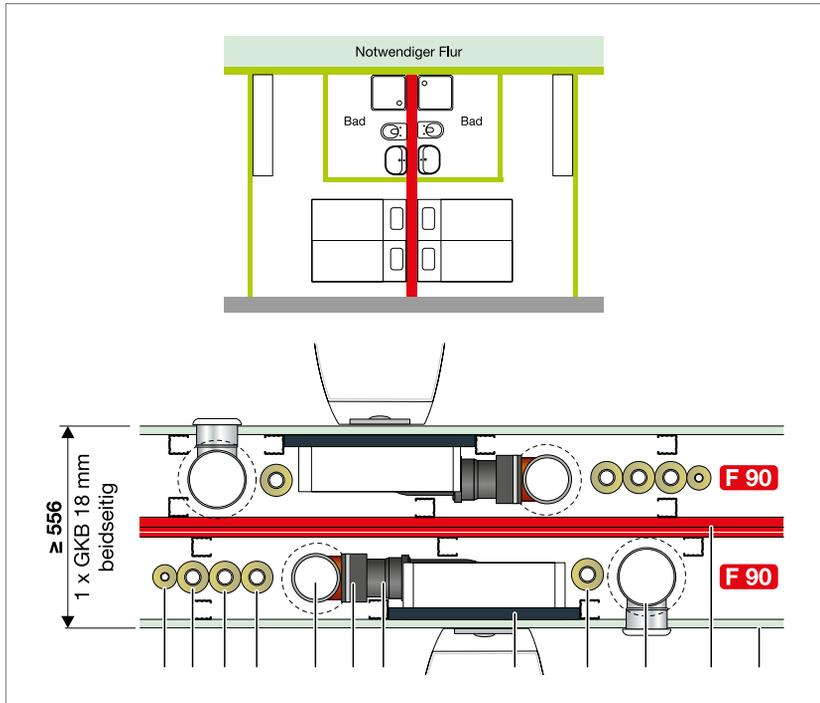
Abb. 220: F 90 Leichte Trennwand mit beidseitiger Wandbelegung
