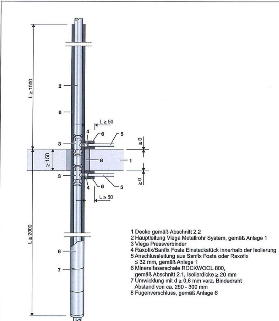
Abschottung für Rohrleitungen aus Metall mit Anschlussleitungen aus Kunststoff „Viega Mischinstallation Versorgung“
