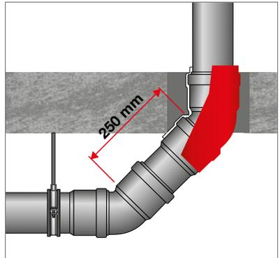
Abb. 266: Umlenkung am Fallstrang,
