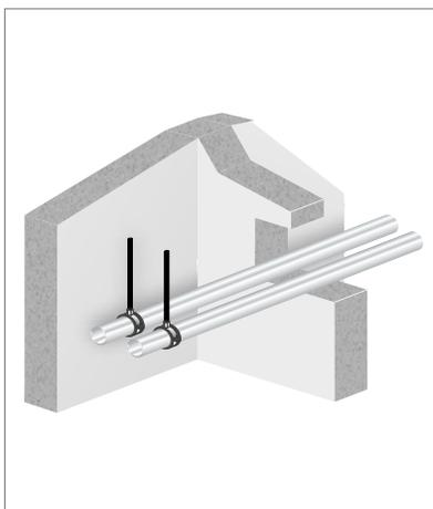
Abb. 248: Rohrschelle mit Versorgungsleitungen - Einbausituation Wand
