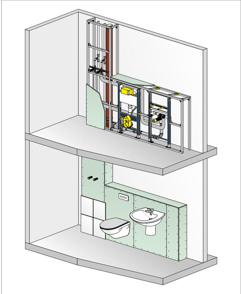
Abb. 285: Vorwand-Installation vor Massivwand mit Prevista Dry Plus
