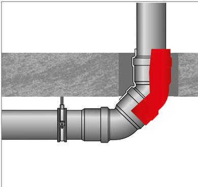
Abb. 265: Umlenkung am Fallstrang
