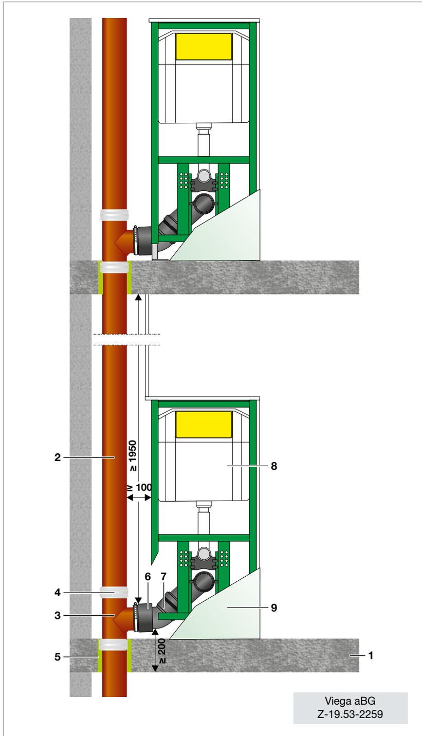
Abb. 46: Aufbau Mischinstallation, „Viega Spülkästen mit Guss-Abflussleitungen“
