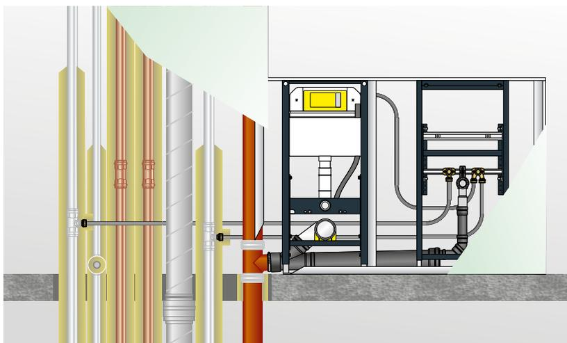
Abb. 56: Wirtschaftlicher Schachtaufbau mit Guss SML Falleitung
