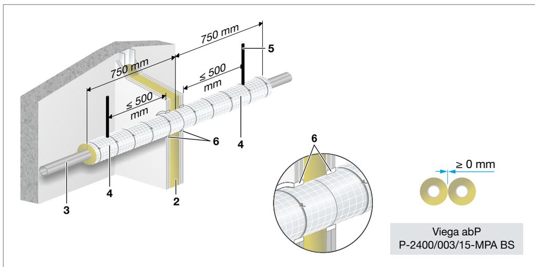
Abb. 155: Prestabo/Prestabo PP-ummantelt – Einbau in leichte Trennwand
