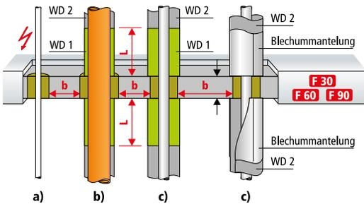
Mindestbauteildicke der Decke oder Wand entsprechend der geforderten Feuerwiderstandsdauer, siehe Bild A-II-4/18
