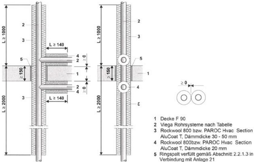
Alle Schalen sind mit verz. Bindedraht  $d \geq 0,7$  mm mit 6 Wicklungen lfd. M. zu fixieren
