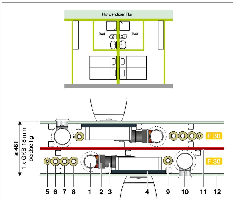
Abb. 219: F 30 Leichte Trennwand mit beidseitiger Wandbelegung
