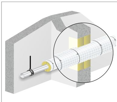
Abb. 195: Dämmung durch Weichschott hindurchgeführt – Wand
