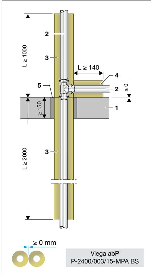
Abb. 77: Etagenanbindung mit Sanpress/Sanpress Inox – oberhalb der Decke
