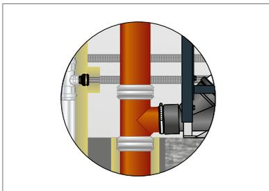
Der Anschluss der Objekte kann direkt mit Raxofix im Schutzrohr (max. 5 Leitungen  $\leq 32$  mm) erfolgen.
