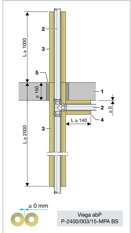
Abb. 78: Etagenanbindung mit Sanpress/Sanpress Inox – unterhalb der Decke
