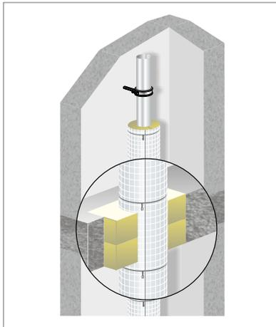
Abb. 193: Dämmung durch Weichschott hindurchgeführt – Decke
