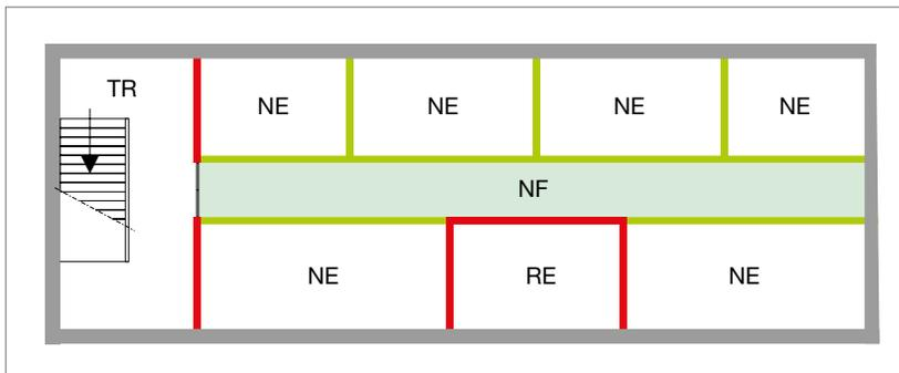
Abb. 176: Notwendiger Flur und Trennwände nach Musterbauordnung — MBO
