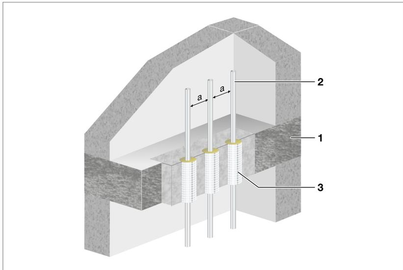
Abb. 185: Deckendurchführung Fonterra Rohre/Raxofix/Sanfix Fosta nach LAR
