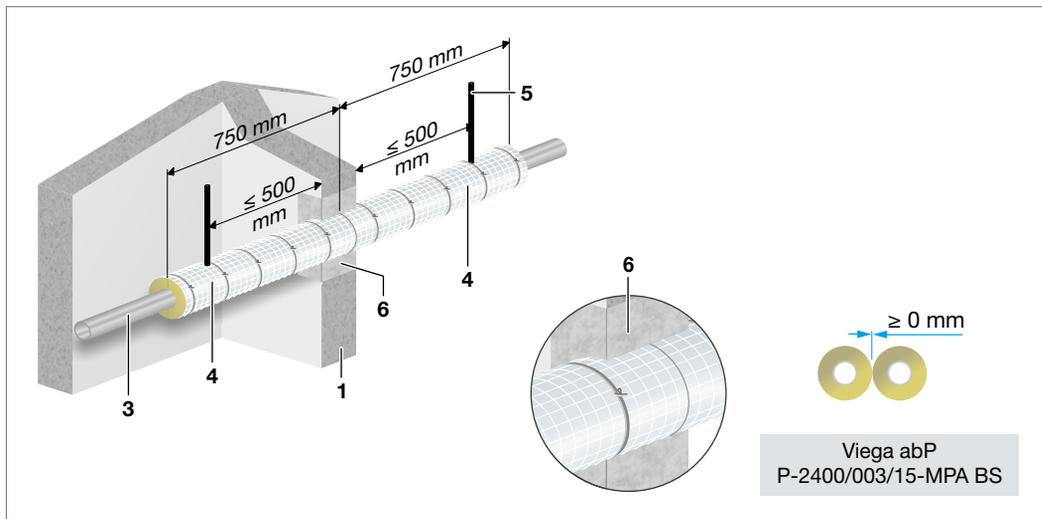
Abb. 154: Prestabo/Presstabo PP – Einbau in Massivwand
