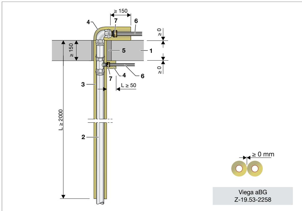
Abb. 79: Etagenanzbindung/oberstes Geschoss mit Sanpress/Sanpress Inox und Übergang auf Raxofix/Sanfix Fosta
