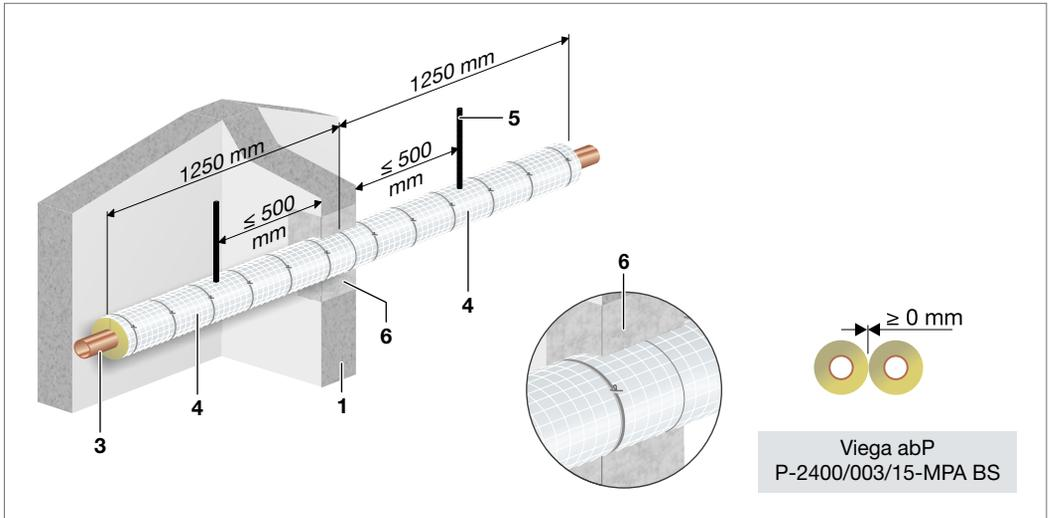
Abb. 150: Profipress/Profipress mit Smartloop Inliner-Zirkulation – Einbau in Massivwand
