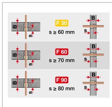
Abb. 187: Mindestabschottungsdicken bei Decke und Wand (deutsche Leitungsanlagen-Richtlinie)
