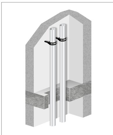
Abb. 249: Rohrschelle mit Versorgungsleitungen - Einbausituation Decke
