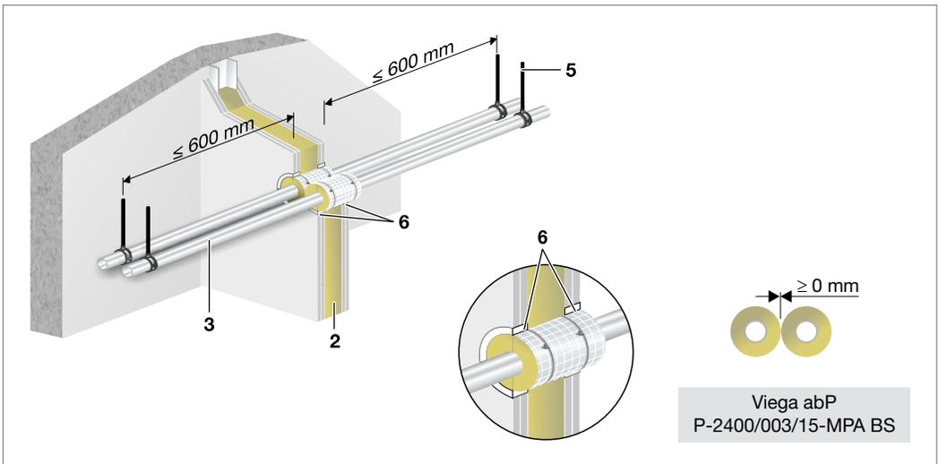
Abb. 163: Raxinox – Einbau in leichte Trennwand
