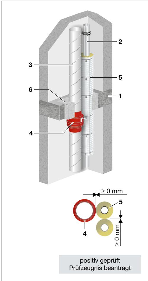
Abb. 137: 0-Abstand zu Absperrvorrichtungen
