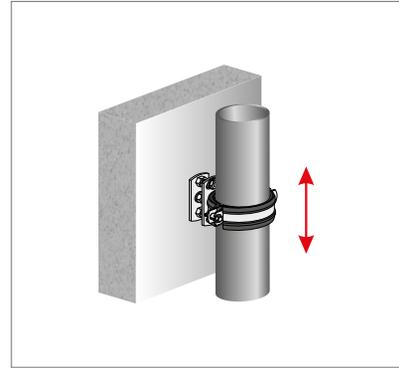
Abb. 251: Rohrschelle mit Entsorgungsleitungen – Beispiel: Gleitschelle
