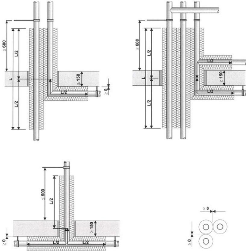
Alle Schalen sind mit verz. Bindedraht  $d \geq 0,7$  mm mit 6 Wicklungen lfd. M. zu fixieren
