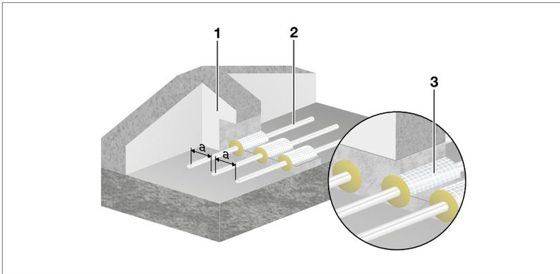
Abb. 186: Wanddurchführung Fonterra Rohre/Raxofix/Sanfix Fosta nach LAR
