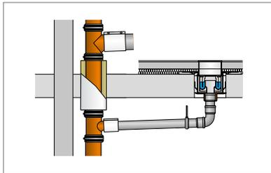
Abb. 221: Viega Advantix R 120 Bodenablauf und Rohrdurchführung – Mischinstallation
