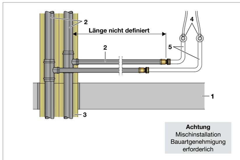
Abb. 44: Rohrwechsel in der Nutzungseinheit ist Mischinstallation
