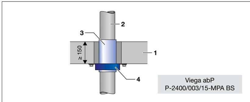
Abb. 128: Rohrdurchführung gerade bis DN 100, mit Brandschutzmanschette
