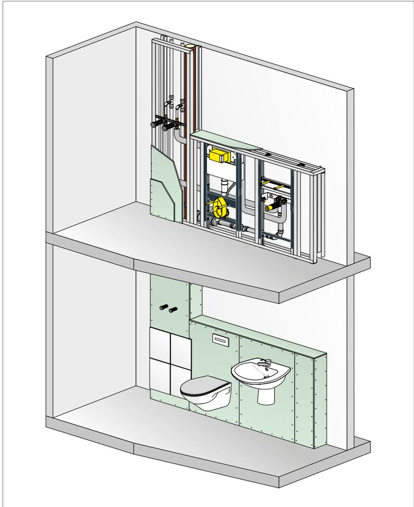
Abb. 288: Vorwand-Installation mit Viega Prevista Dry vor Massivwand
