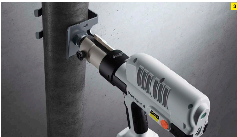
3. Einpressanschluss mithilfe des Pressmaschineneinsatzes und der Positionierungshilfe in das Rohr einpressen.
