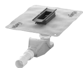
Modell: 4981.80 Ablaufkörper Standard Aufbauhöhe: 95–155 mm Sperrwasserhöhe: 50 mm Ablaufleistung: 0,5–0,7 l/s*
