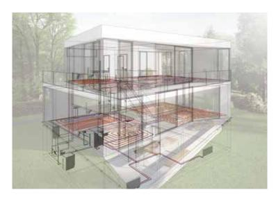
Vereinfachen Sie die Heizlastberechnung durch den Gebäudemanager. Egal, ob eingescannte Zeichnung oder digitaler 2D-Entwurf im DXF-, DWG- und PDF-Format, die Grundrisserfassung des Gebäudemanagers verwandelt jede zweidimensionale Vorlage mit wenigen Arbeitsschritten in ein 3D-Modell. Für die Heizund Kühllastberechnung übergeben Sie das Gebäude an Viptool Building. Nach Auslegung der Flächenheizung oder der Heizkörper können Sie diese in das 3D-Modell einzeichnen.
