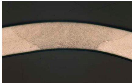
Herkömmliche breite WIG-Schweißnaht
