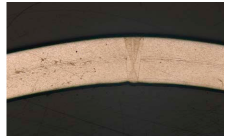
Schmale Viega Laserschweißnaht
