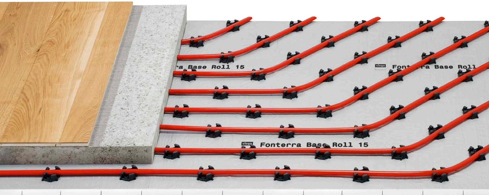
Das neuartige Flächentemperiersystem zum Heizen und Kühlen basiert auf einer ausrollbaren Systemplatte und einem neuartigen Rohrclip. So kombiniert Fonterra Base Roll 15 die einfache Montage eines Tackersystems mit der sicheren Fixierung eines Noppensystems.
