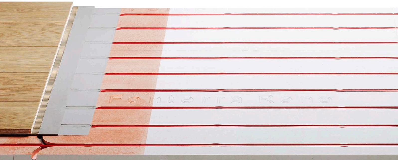
Fonterra Reno erlaubt mit seinen nur 18 mm dicken Systemplatten aus Gipsfasermaterial auch in Räumen, die nur eine minimale Bauhöhe zulassen, den Einbau einer leistungsstarken Fußbodenheizung. Dabei lassen sich die Systemplatten je nach gewünschtem Bodenbelag entweder direkt verfliesen, vergießen oder mit einer Ausbauplatte zur Anpassung der Aufbauhöhe belegen.
