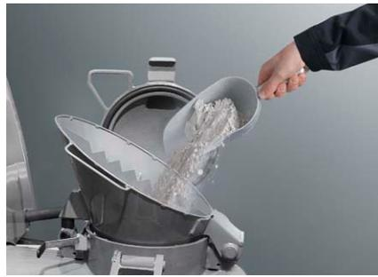
Durch Zugabe des speziellen Fonterra Base Flat-Estrichzusatzmittels lässt sich aus handelsüblichem Zementestrich extraflacher Spezial-Heizestrich machen.
