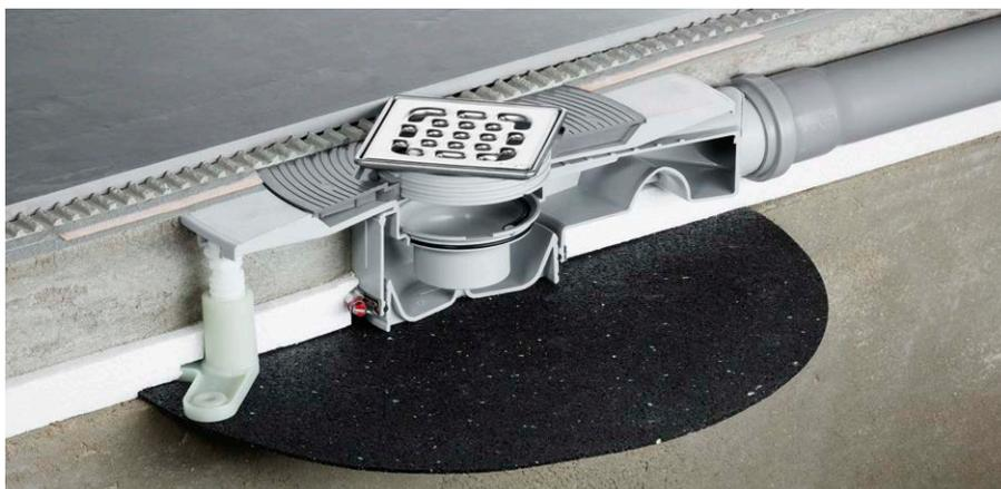
Advantix Top-Ablauf rücksaugstark durch Sperrwasserbarriere mit mittlerer Durchlauföffnung und seitlichen Stautaschen.
