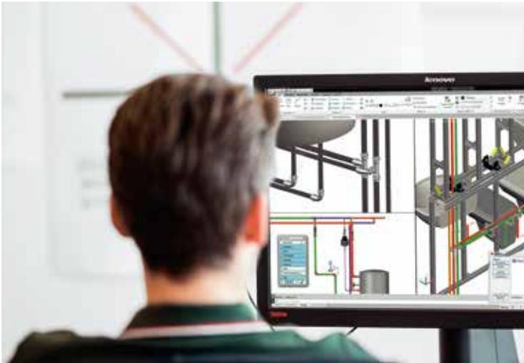
In diesem Seminar konstruieren Sie mithilfe des 3D-Ein-Strich-Netzes automatisiert die 3D-Volumenkörperdarstellung. Dazu werden die Gebäudedaten des Architekten per IFC-Import-Funktion eingelesen. Falls es bei der 3D-Rohrnetzkonstruktion zu Kollisionen kommt, hilft Ihnen die Kollisionsprüfung weiter. Die Fehler werden durch die manuelle Bearbeitung beseitigt. Neutrale Komponenten können gegen Herstellerdaten ausgetauscht werden. Das fertige Netz wird per IFC-Export-Funktion weitergegeben.
