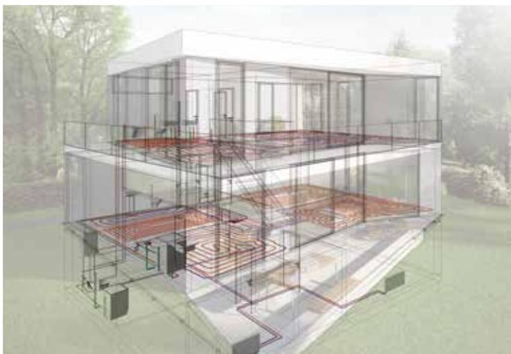
Vereinfachen Sie die Heizlastberechnung durch den Gebäudemanager. Egal, ob eingescannte Zeichnung oder digitaler 2D-Entwurf im DXF-, DWG- und PDF-Format, die Grundrisserfassung des Gebäudemanagers verwandelt jede zweidimensionale Vorlage mit wenigen Arbeitsschritten in ein 3D-Modell. Für die Heiz- und Kühllastberechnung übergeben Sie das Gebäude an Viptool Building. Nach Auslegung der Flächenheizung oder der Heizkörper können Sie diese in das 3D-Modell einzeichnen.
