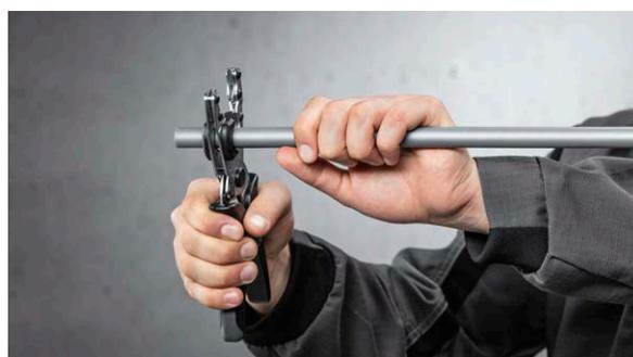
Das formstabile Raxinox-System lässt sich genauso einfach verarbeiten wie jedes andere Mehrschichtverbundrohr: Vom passgenauen Ablängen des Rohres mit der Handschere ...
