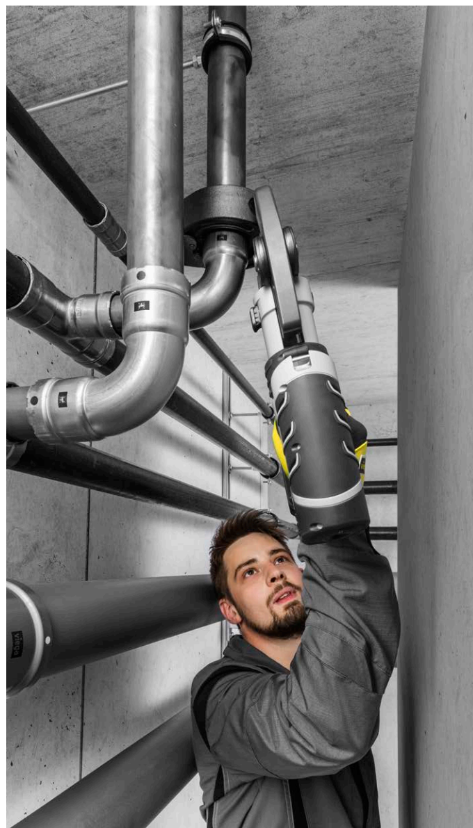
Perfekte Flexibilität: Mit der um echte 360° drehbaren Pressbackenaufnahme und der Gelenkzugbacke kann selbst unter extrem beengten Platzverhältnissen problemlos ohne großen Kraftaufwand verpresst werden.
