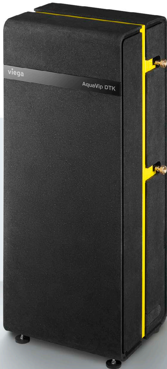
Die Verteilung von Trinkwasser kalt (PWC) in einer Zirkulation mit einem Durchlauf-Trinkwasserkühler wie dem Viega AquaVip-DTK ist eine hygienisch sichere Lösung, PWC-Temperaturen unter 20 °C zu halten.
