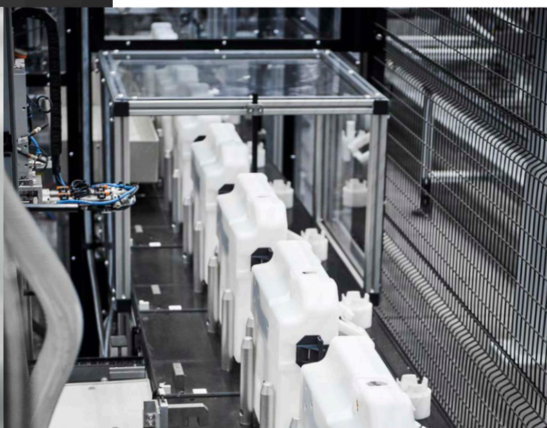
100% sicher: Jeder einzelne Spülkasten wird mehrfach auf Dichtheit geprüft.
