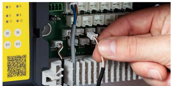
**Fehler ausgeschlossen: Die steckerfertige Zuordnung für Stellantriebe und Temperatursensoren lässt keine Frage offen.**
