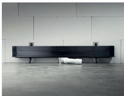
Abb. 280: Neben den schalldämmenden Montagefüßen entkoppelt zusätzlich ein Schallschutzband die Befestigungselemente vom Baukörper.
