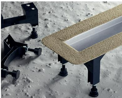
Abb. 284: Advantix-Duschrinnen in der Schallprüfung
