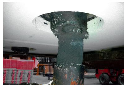
Abb. 248: nach Brandversuch - Gussleitung verschlossen
