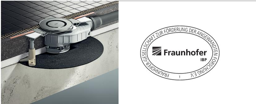
Abb. 282: Nicht nur die Schallentkopplung der Montagefüße ist wichtig. Durch die im Lieferumfang enthaltene Schallschutzmatte lassen sich sowohl die Funktionsgeräusche als auch der Trittschall erheblich reduzieren. Der Ablauf Advantix-Top erfüllt alle Schallschutzstufen nach der VDI-Richtlinie 4100.
