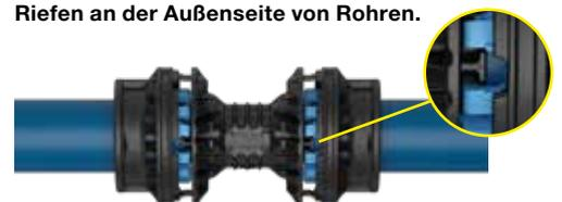
Die Sichtfenster der Verbinder ermöglichen es, die Einstecktiefe der Rohre vor dem Verpressen zu überprüfen.
