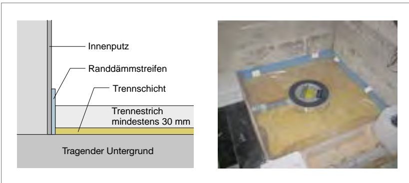
Abb. 285: Der Randdämmstreifen muss lückenlos und vollständig auch hinter dem Bodenablauf durchgeführt werden und dabei großzügig über der Estrich-Oberkante überstehen.
