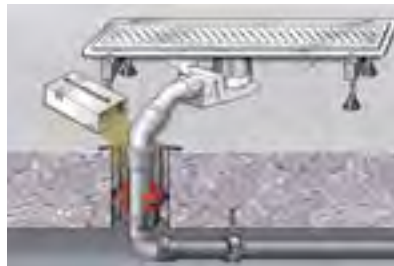
Abb. 234: Rohrdurchführung bei Advantix-Duschrinne
