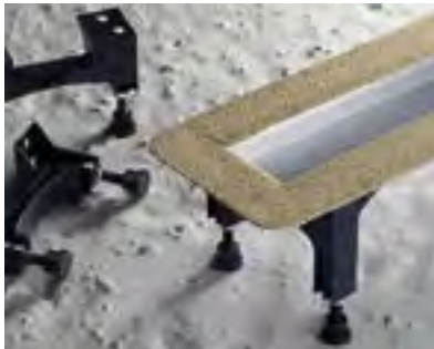
Abb. 280: Advantix-Duschrinnen in der Schallprüfung
