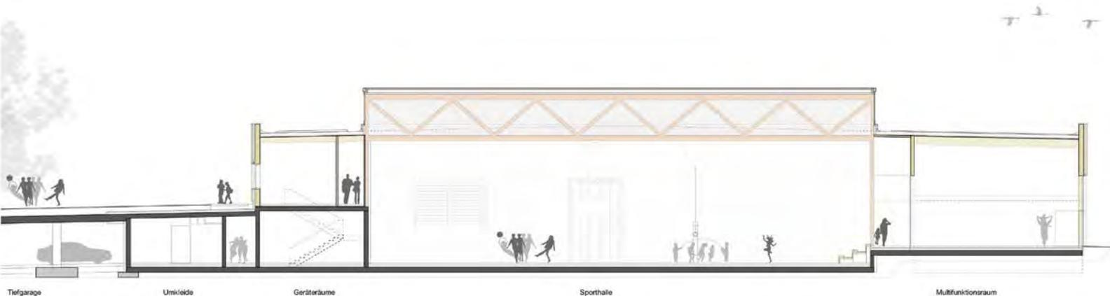
Sowohl für die Stützen als auch für das Dachtragwerk kam Buchen-Furnierschichtholz zum Einsatz. Die schlanken Querschnitte, die hellen Farben im Gebäudeinnern und das über die sheddachartigen Konstruktionen einfallende Tageslicht sorgen für eine freundliche Atmosphäre und optimale Bedingungen beim Sport.
