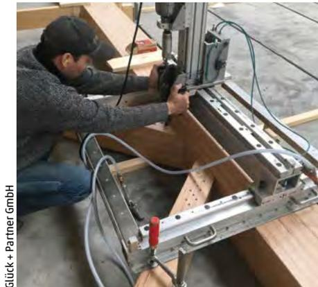
Mit einem Setzgerät lassen sich die Verbindungsmittel präzise in die BauBuche-Bauteile einbringen.
