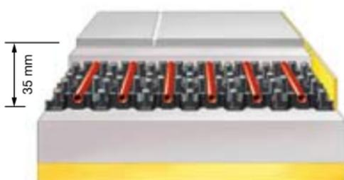
Bodenaufbau Fonterra Base Flat 12.
