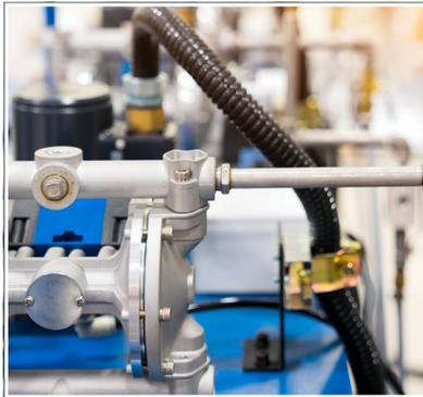
Abb. 120: Druckluft-Membranpumpe
