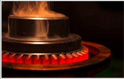
Abb. 136: Schutzgasöfen zur Härtung von Zahnrädern
