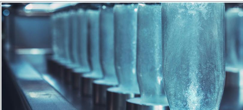
Abb. 102: Durch Prozesswärme erhitztes Wasser zur Reinigung von Flaschen
