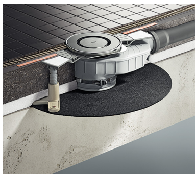
Abb. 282: Nicht nur die Schallentkopplung der Montagefüße ist wichtig. Durch die im Lieferumfang enthaltene Schallschutzmatte lassen sich sowohl die Funktionsgeräusche als auch der Trittschall erheblich reduzieren. Der Ablauf Advantix-Top erfüllt alle Schallschutzstufen nach der VDI-Richtlinie 4100.
