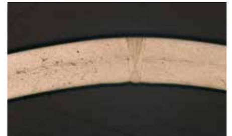
**Schmale Viega Laserschweißnaht**
