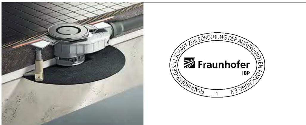
Abb. 242: Nicht nur die Schallentkopplung der Montagefüße ist wichtig. Durch die im Lieferumfang enthaltene Schallschutzmatte lassen sich sowohl die Funktionsgeräusche als auch der Trittschall erheblich reduzieren. Der Ablauf Advantix-Top erfüllt alle Schallschutzstufen nach der VDI Richtlinie 4100.
