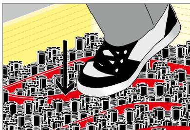
Abb. 44: Rohre entsprechend den Berechnungsdaten verlegen.
