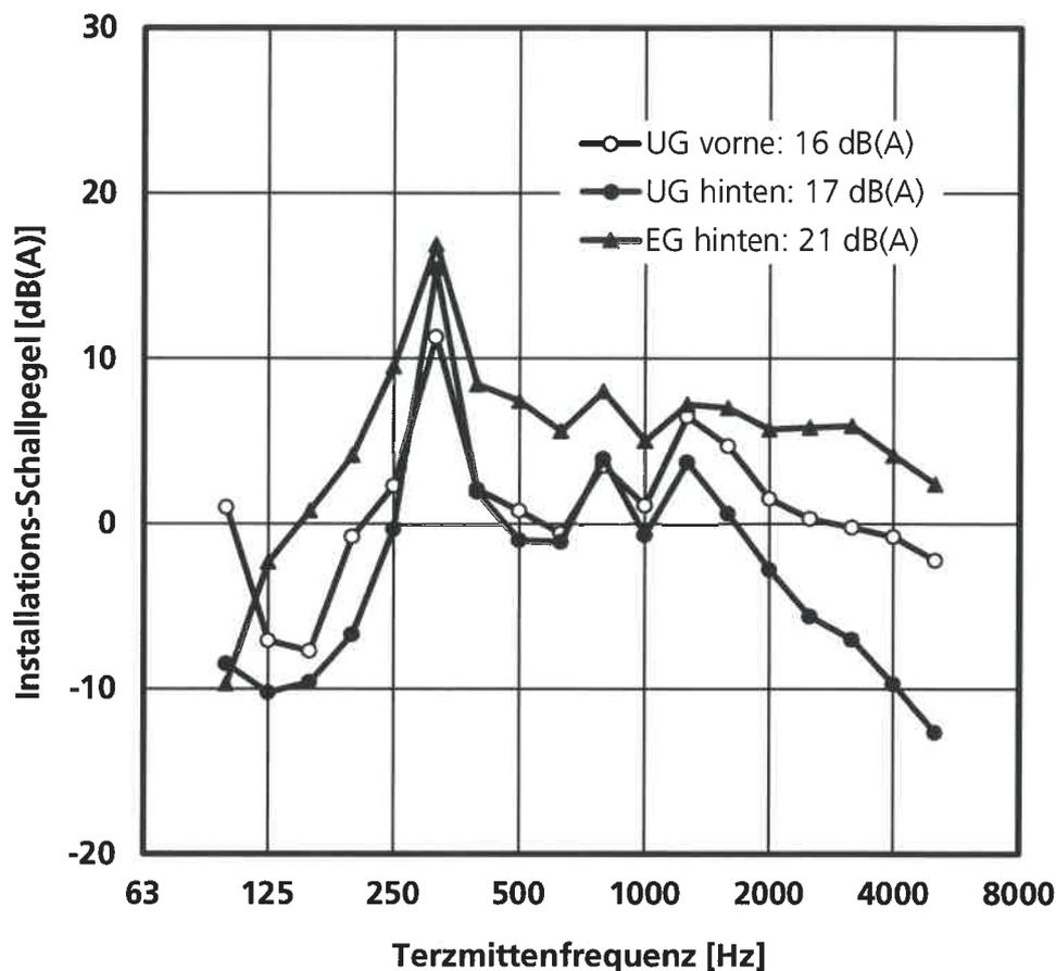
Frequenzverlauf des Installations-Schallpegels bei Geräuschanregung mit dem Körperschall-Geräuschnormal (KGN), gemessen in den Räumen UG vorne, UG hinten und EG hinten. In der Legende sind die Installations-Schallpegel  $L_{A\text{Freq},n}$  in dB(A) nach DIN 4109 für den abgebildeten Frequenzbereich von 100 bis 5000 Hz angegeben.
