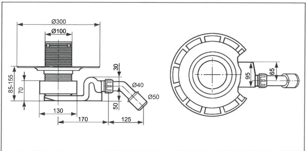
Badablauf aus Kunststoff "Advantix, 4927, 557058, DN40/50" der Firma Viega und "Geruchssperre 4936.6" (Zeichnungen des Auftraggebers).
