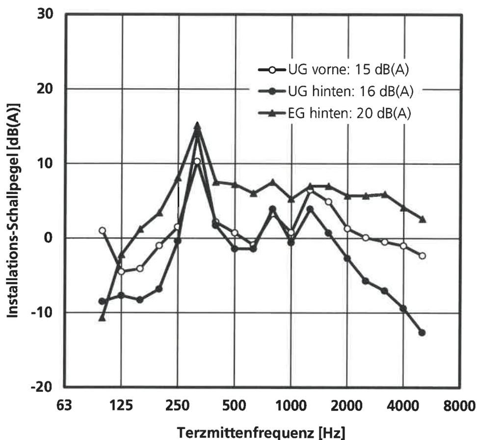
Frequenzverlauf des Installations-Schallpegels bei Geräuschanregung mit dem Körperschall-Geräuschnormal (KGN), gemessen in den Räumen UG vorne, UG hinten und EG hinten. In der Legende sind die Installations-Schallpegel  $L_{A\text{Feg},n}$  in dB(A) nach DIN 4109 für den abgebildeten Frequenzbereich von 100 bis 5000 Hz angegeben.
