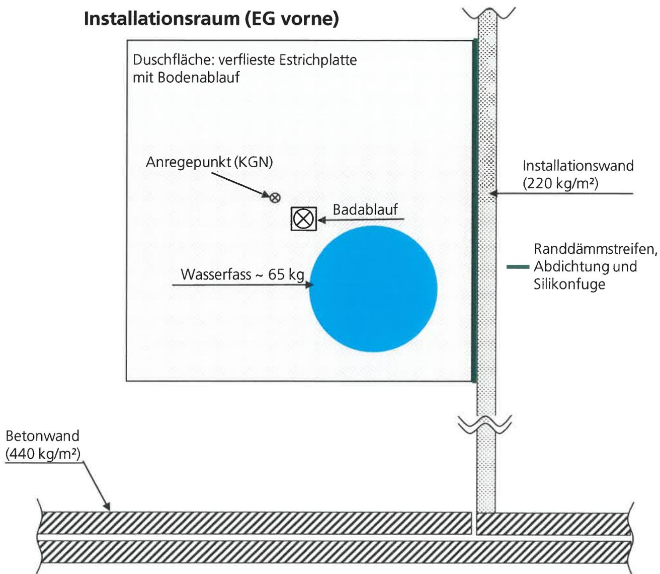
Lage des Prüfaufbaus im Installationsraum (EG vorne).
